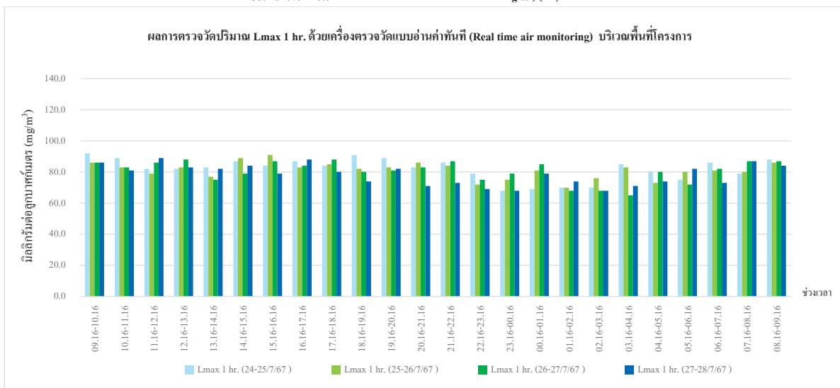
กราฟรูปที่ 17 กราฟแสดงผลการทดสอบเสียงด้วยเครื่อง Sound level meter แสดงผลแบบอ่านค่าทันทีบนหน้าจอ Digital วันที่ 24-28 กรกฎาคม 2567 บริเวณพื้นที่โครงการ
