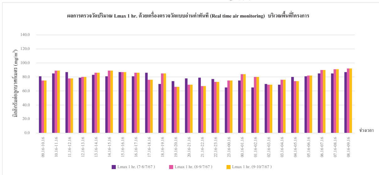
กราฟรูปที่ 12 กราฟแสดงผลการทดสอบเสียงด้วยเครื่อง Sound level meter แสดงผลแบบอ่านค่าทันทีบนหน้าจอ Digital วันที่ 7-10 กรกฎาคม 2567 บริเวณพื้นที่โครงการ
